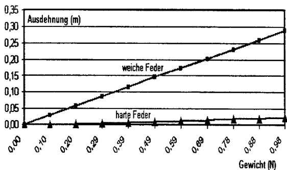
Diese Daten können nun verwendet werden um den Zusammenhang zwischen Kraft und Dehnung in Termform zu beschreiben. Um die „beste“ Darstellung (im Sinne der Minimierung der quadratischen Abweichung) des vermuteten linearen Zusammenhanges zwischen den Beobachtungsgrößen zu finden kann etwa die FIT-Funktion von Derive als Black-Box verwendet werden.
